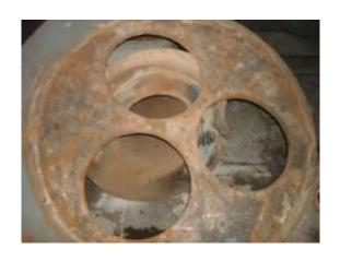
На металлургическом предприятии происходит регулярное прогорание крышки промковша из-за касания электродами, корпуса проходящими через отверстия. Это вызывает аварии, простой оборудования в течение минимум 2 А это срыв часов. СРОКОВ 3**GKG3OB** выполнения И непредвиденные расходы.
