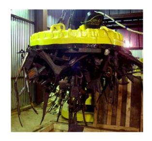
При подъеме металла электромагнитом кабеле на образуется петля.
